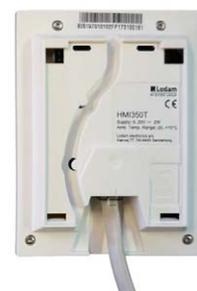
La prise RJ12 se branche dans le bas du panneau HMI et le câblage peut être acheminé le long du mur, dans le mur ou à travers la rainure marquée à l'arrière du panneau.
