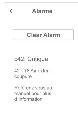
Une fois le problème réglé, l'avertissement ou l'alarme peut être réinitialisé en appuyant sur "Clear Alarm".
