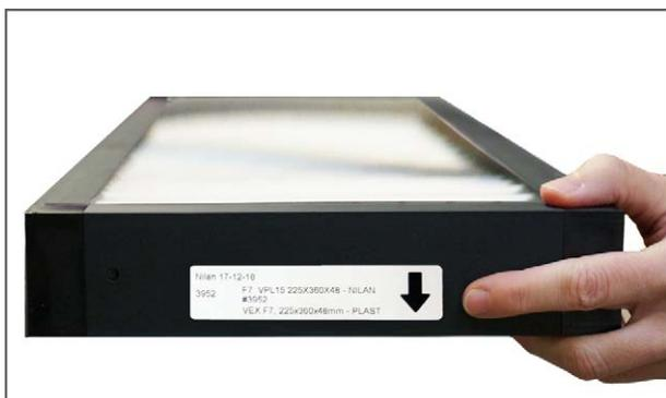
5. Le nouveau filtre doit basculer avec la flèche à l'écart des connexions de la gaine. Le filtre est placé dans les pistes marquées et la porte se ferme à nouveau.
