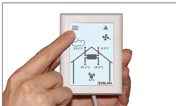
8. Dans le menu ALARME du panneau de commande, appuyez sur le symbole de l'alarme en haut à droite et réinitialisez l'alarme ici.
