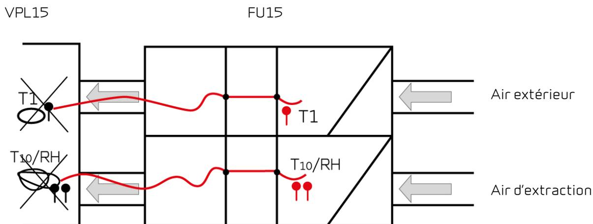
Les capteurs de température T1, T10 et d'humidité HR doivent être déplacés comme indiqué sur le schéma. Il est important de les déplacer avant le caloduc pour que l'appareil puisse fonctionner correctement.
