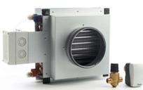
Un panneau de chauffage d'eau permet de hausser la température de l'air d'alimentation au niveau désiré. Le panneau de chauffage d'eau est destiné pour l'installation des canaux et doit être raccordé à la distribution de chaleur primaire.
