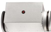
Un panneau de chauffage électrique permet de hausser la température de l'air d'alimentation au niveau désiré. Le panneau de chauffage électrique est prévu pour une installation dans la conduite d'air d'alimentation, et est fourni avec les sondes nécessaires.
