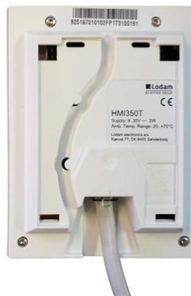
Le connecteur RJ12 est connecté à la base du panneau tactile et le câble peut être conduit vers le bas le long du mur, dans le mur ou à travers l'emplacement sélectionné à l'arrière du panneau.
