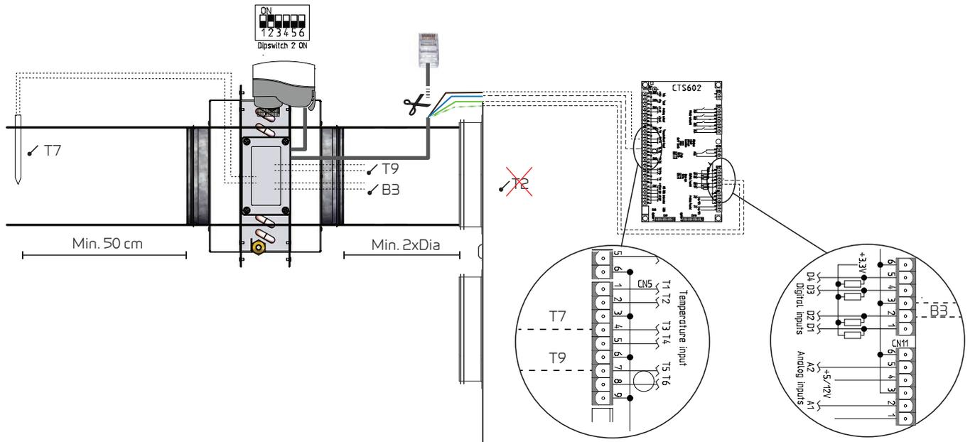
Les fils sont montés dans un connecteur RJ 45 T568 de type A, coupé et monté dans l'unité conformément au schéma électrique.
