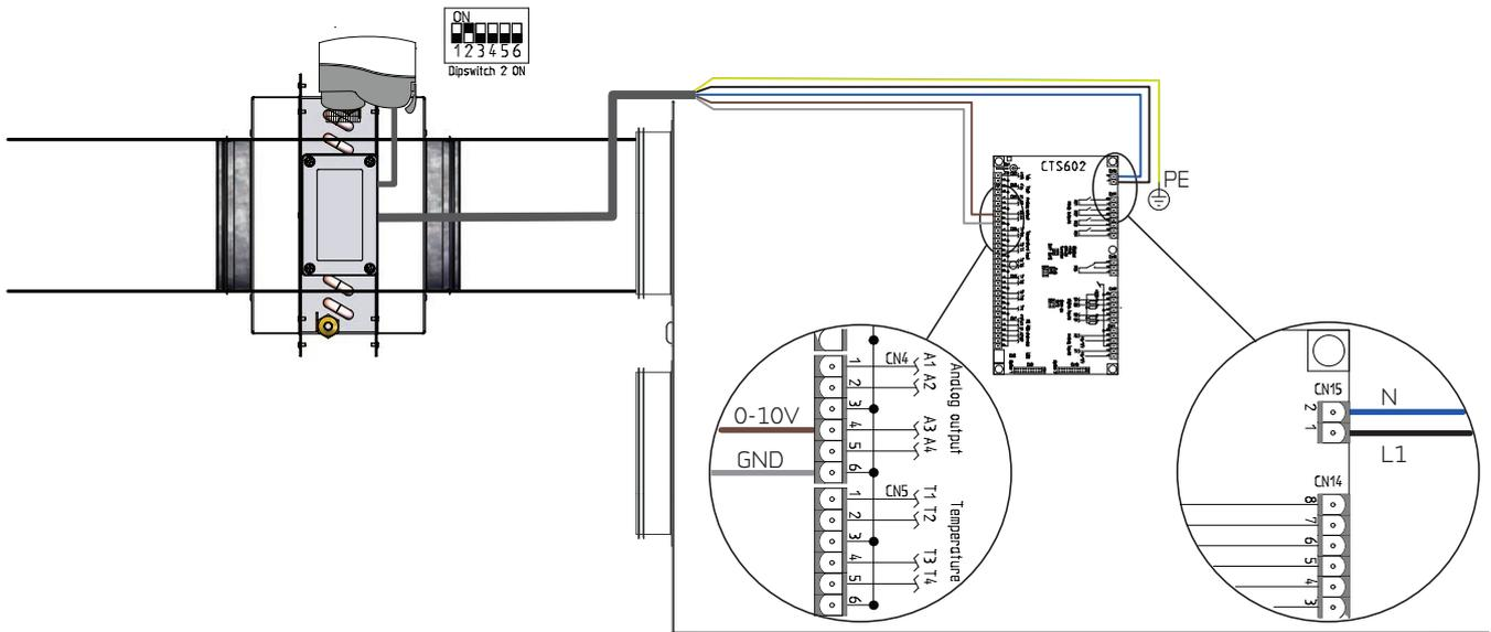
Les fils sont acheminés le long du canal et montés dans l'unité conformément au schéma électrique.
