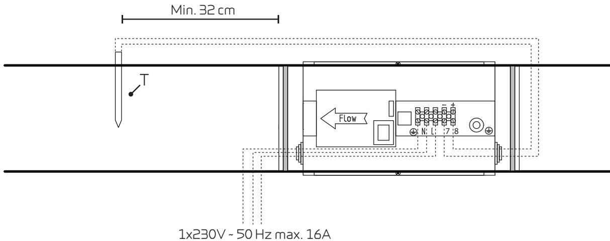
Il est important de placer le capteur de température au moins à 32 cm du panneau de préchauffage pour assurer une bonne régulation.
