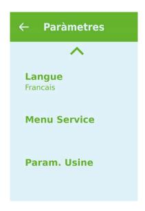
Pour accéder au menu de service, il faut disposer d'un mot de passe. Pour régler le mot de passe, il faut appuyer sur la flèche, vers le haut ou vers le bas, et finir par l'icône "accepter" en bas à droite.
