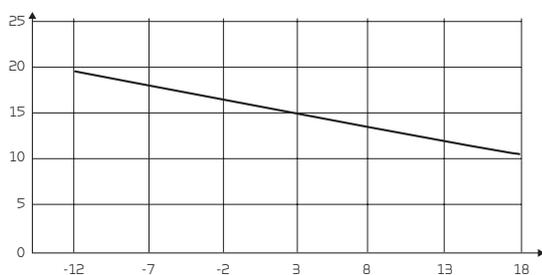
Puissance de transfert de chauffage  $Q_c$  [W] en fonction du débit  $q_v$  2400 m³/h et l'air extérieur [°C]. Selon EN 14511, air extrait = 20 °C.
