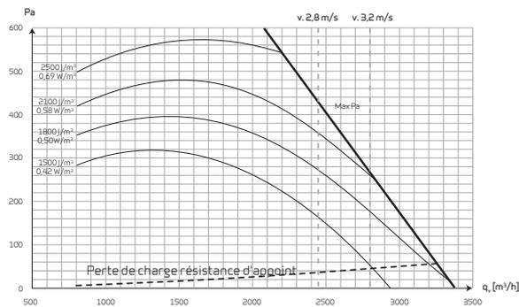
Capacité Max Pa d'une centrale, Pt, ext en fonction du débit  $q_v$ , pour valeurs SFP selon EN13053 pour une centrale avec des filtres ISO ePM10 >60% (M5) & ISO ePM1 50% (F7), sans accessoires. Le débit sur l'évaporateur est mesuré en mètre par seconde.
