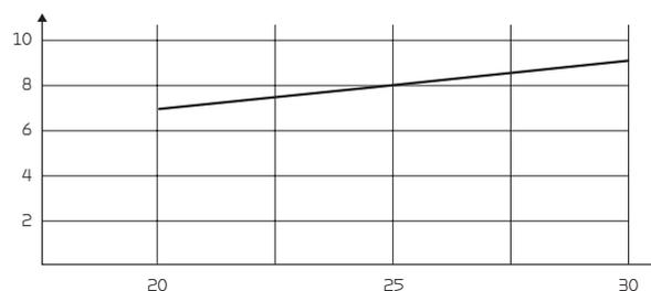
Température d'air soufflé [°C] en fonction de la température extérieure [°C] et le débit  $q_v$  2400 m³/h. Température d'air extrait = 25 °C
