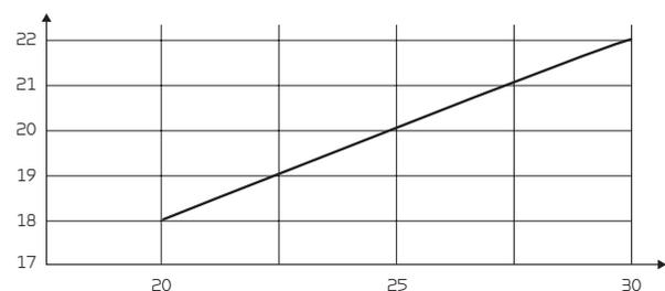
Température d'air soufflé [°C] en fonction de la température extérieure [°C] et le débit  $q_v$  5600 m³/h. Température d'air extrait = 25 °C
