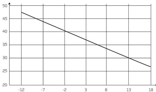
Puissance de transfert de chauffage  $Q_c$  [W] en fonction du débit  $q_v$  5600 m³/h et l'air extérieur [°C]. Selon EN 14511, air extrait = 20 °C.
