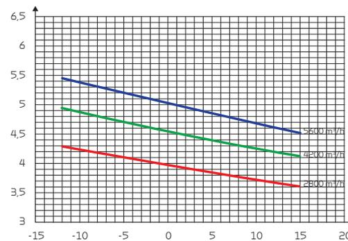
COP [-] de l'air soufflé en fonction de l'air extérieur [°C] et débit d'air  $q_v$  [m³/h]. Selon EN14511, air extrait = 21 °C.
